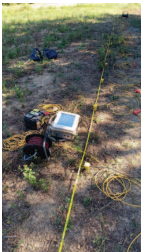
FOTO 1A: postazione di energizzazione SS1
