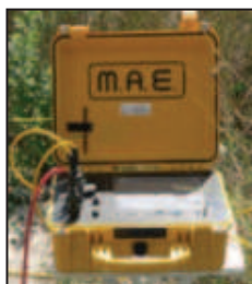
Fig. 2: sismografo multicanale M.A.E. modello A 6000 S.
