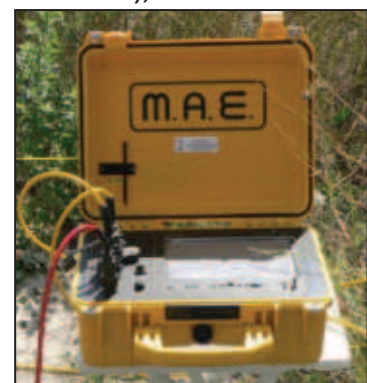
Fig. 3: sismografo multicanale M.A.E. modello A 6000 S.
