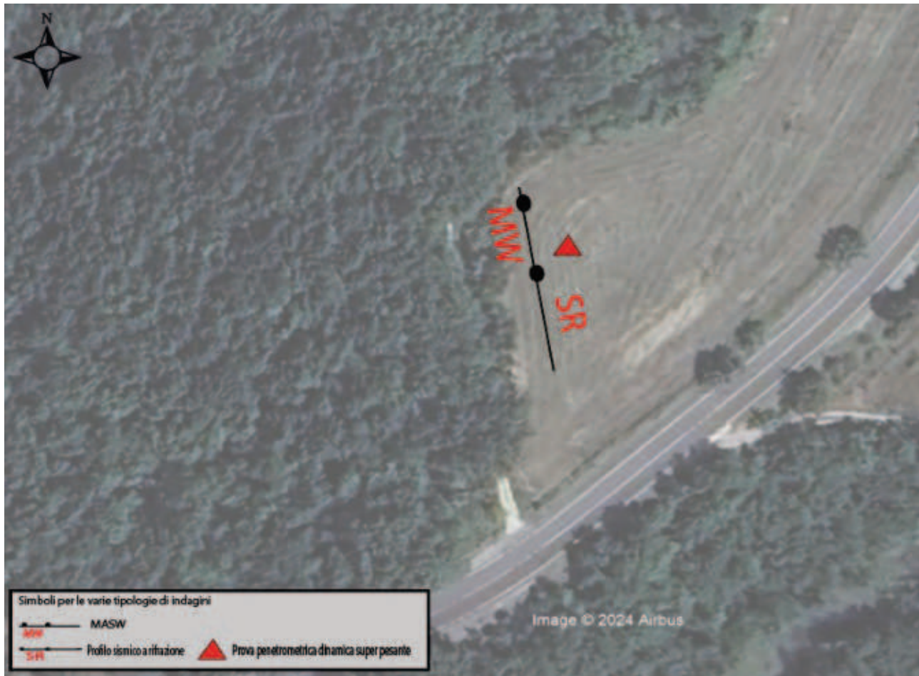
Fig. 14 - Ubicazione delle indagini geotecniche e geofisiche eseguite.
