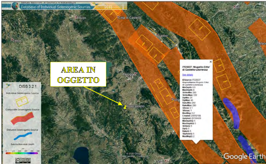
20. Database Sorgenti Sismogenetiche per l'area d'interesse – Database of Individual Seismogenic Sources (DISS version 3.2.1 – INGV)
