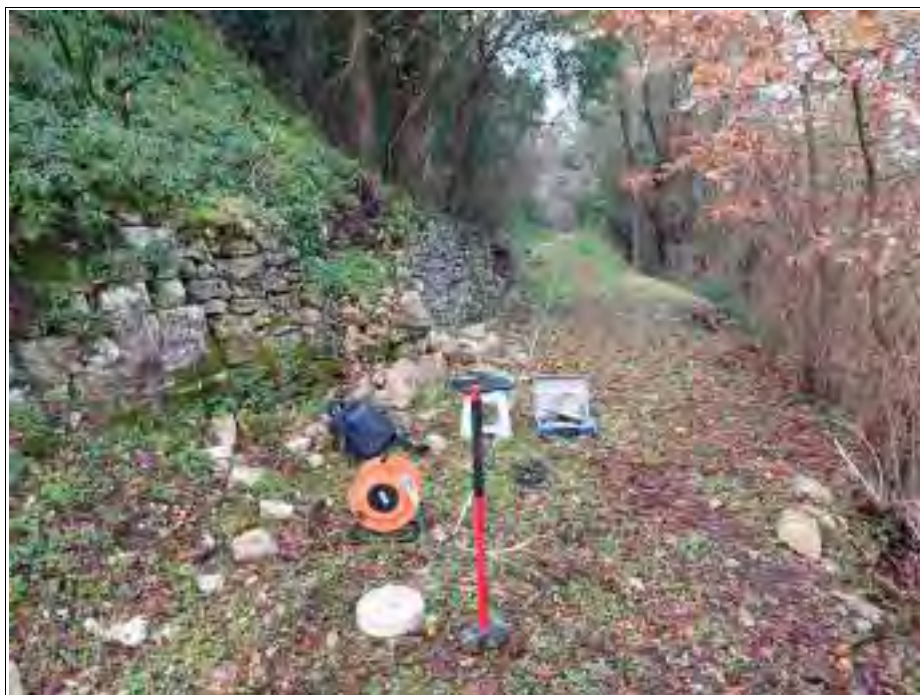
STENDIMENTO GEOFONI E PUNTO BATTUTA PER ACQUISIZIONE MASW N° 2 IN ONDE DI RAYLEIGH (COMPONENTE VERTICALE-ZVF)
