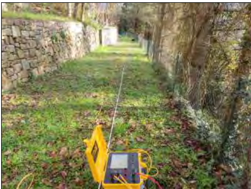
Figura 6 – Georesistivimetro impiegato per le prospezioni geoelettriche.
