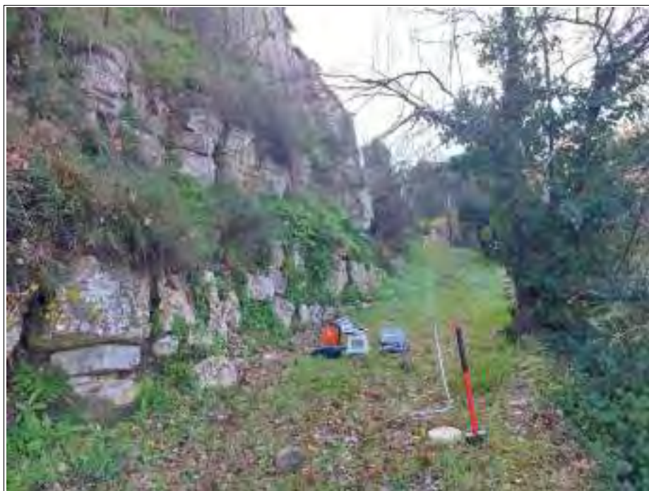
STENDIMENTO GEOFONI E PUNTO BATTUTA PER ACQUISIZIONE MASW N° 3 IN ONDE DI RAYLEIGH (COMPONENTE VERTICALE-ZVF)
