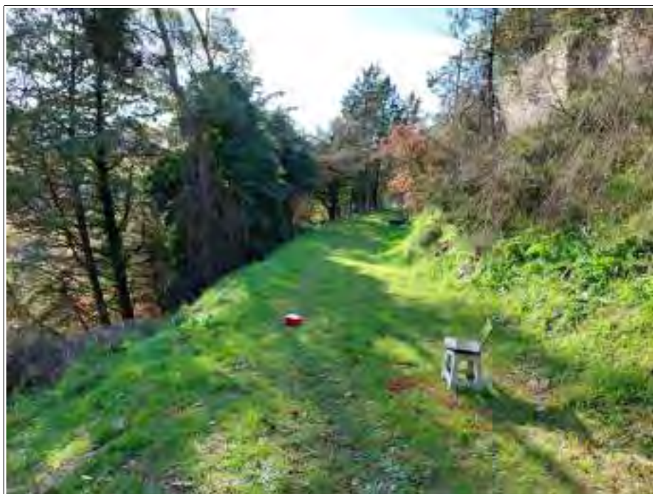
POSIZIONAMENTO GEOBOX PER PROVA H.V.S.R. N° 1
