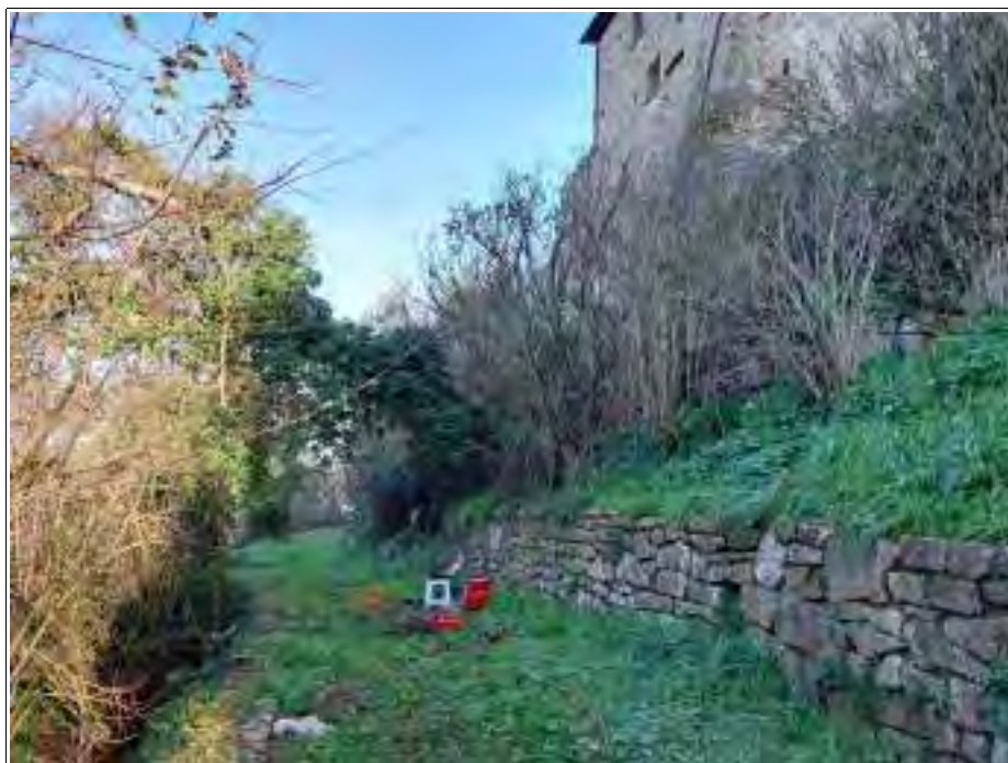
POSIZIONAMENTO GEOBOX PER PROVA H.V.S.R. N° 3
