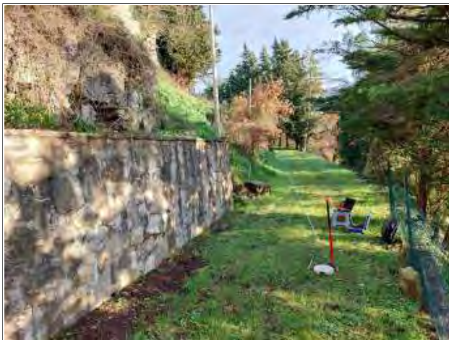
STENDIMENTO GEOFONI E PUNTO BATTUTA PER ACQUISIZIONE MASW N° 1 IN ONDE DI RAYLEIGH (COMPONENTE VERTICALE-ZVF)
