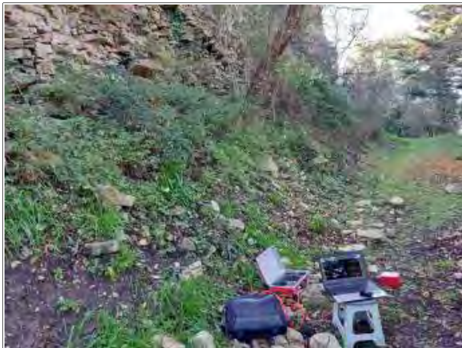
POSIZIONAMENTO GEOBOX PER PROVA H.V.S.R. N° 2
